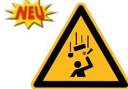
Warnung vor herabfallenden Gegenständen
