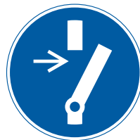
Vor Wartung oder Reparatur freischalten
